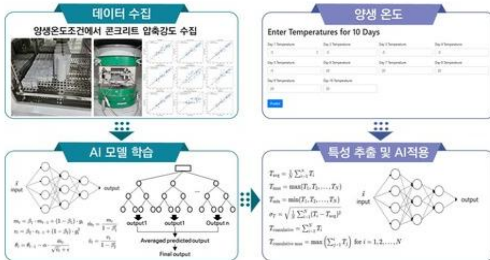
〈그림 4〉 AI 기반 콘크리트 품질관리 예측시스템
